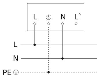
Schéma du circuit d'interconnexion maître/esclave
